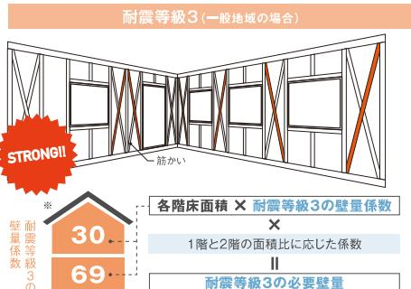
耐震等級1の壁量係数よりも割り増した係数を採用し、面積比率も考慮した上で地震に対して必要となる耐力壁量が決定します。
