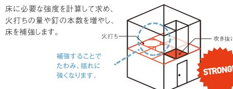
床に必要な強度を計算して求め、火打ちの量や釘の本数を増やし、床を補強します。
