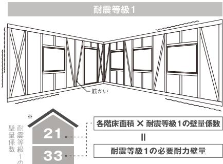
各階の床面積に耐震等級1で決められた係数を乗じて、地震に対して必要となる耐力壁量が決定します。
